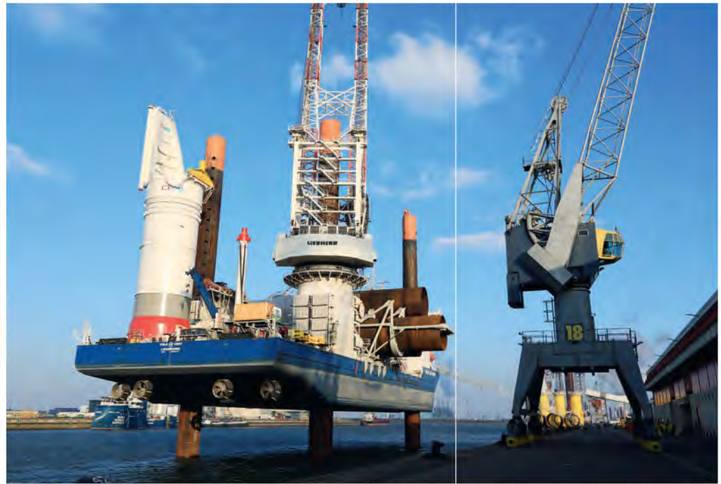
Transition pieces met trijkop voor heien
